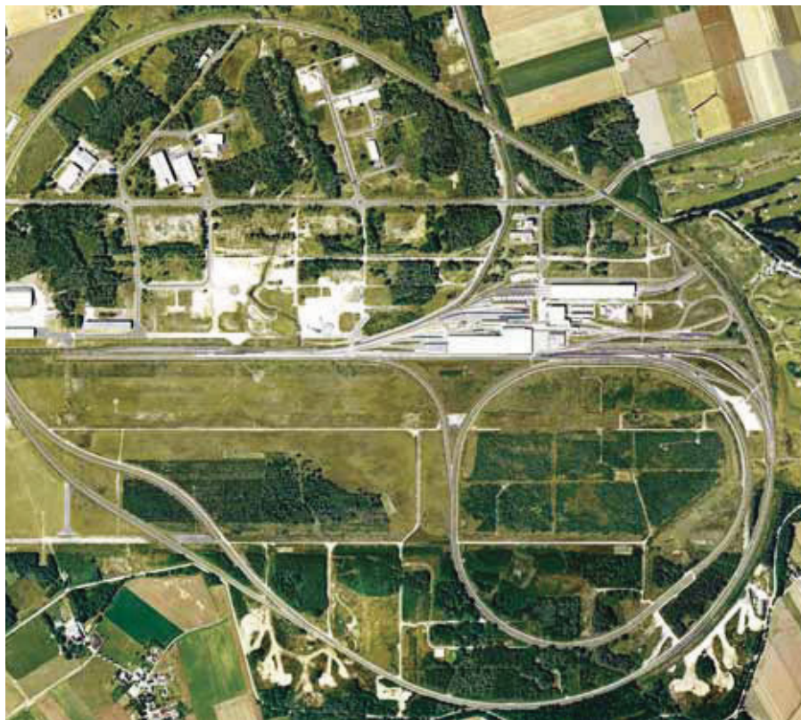
Jazdy ako v reáli: Dva okruhy a tri skúšobné trate merajú dohromady 28 kilometrov. Veľký ovál slúži na testy vysokých rýchlostí – do 160 kilometrov za hodinu.
