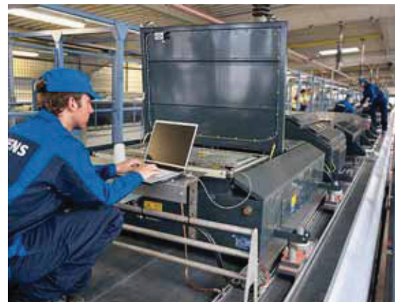
Statické testy: V dvoch veľkých halách sa okrem iného overuje bezpečnosť elektrických systémov, správanie celých vozňov či jednotlivých podvozkov pri náklone.
