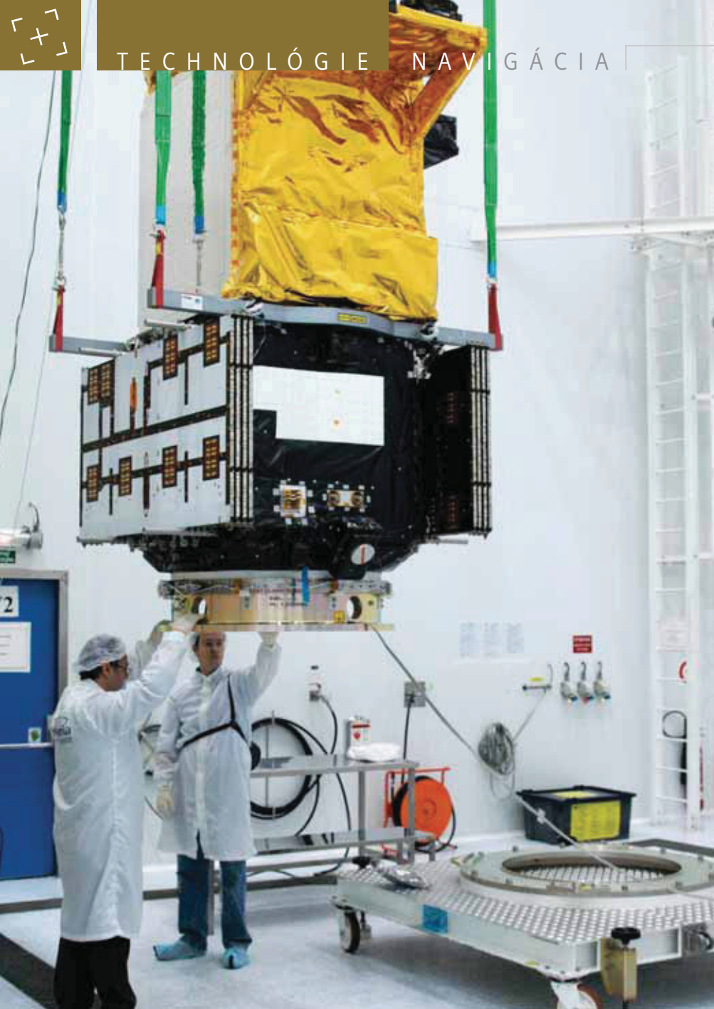
Giove: Testovací satelit odskúšal v rokoch 2005 a 2008 technológiu pre navigačný systém Galileo.
